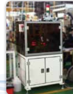
Auto-Part Vision Inspection machine เครื่องวิชั่นตรวจสอบงาน
