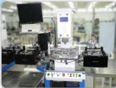
Loader and Unloader ระบบป้อนงานเข้าและออกอัตโนมัติ
