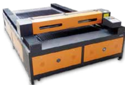
เครื่องเลเซอร์ตัดและแกะสลัก ขนาดใหญ่ Laser Cutting and Engraving Machine
