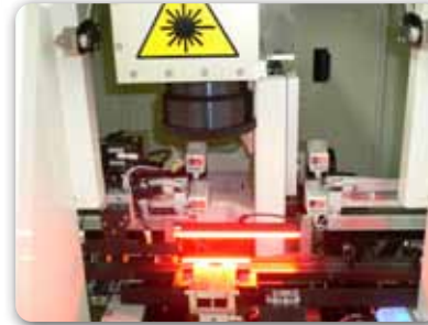
Laser Coding machine เครื่องเลเซอร์ยิงโค้ดบนชิ้นงาน
